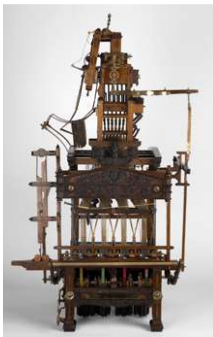
Métier à tisser avec mécanique Jacquard, 1862
